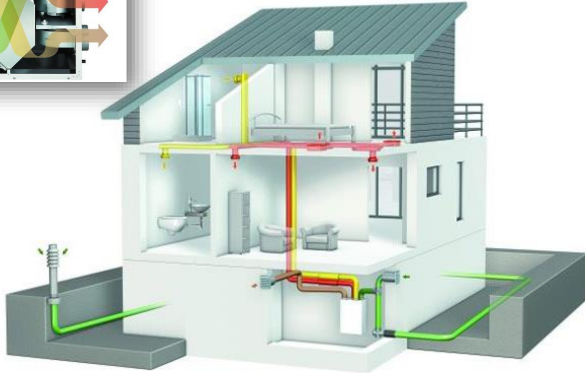
Schema einer Lüftungsanlage mit Wärmerückgewinnung | Bildquelle: © Buderus
