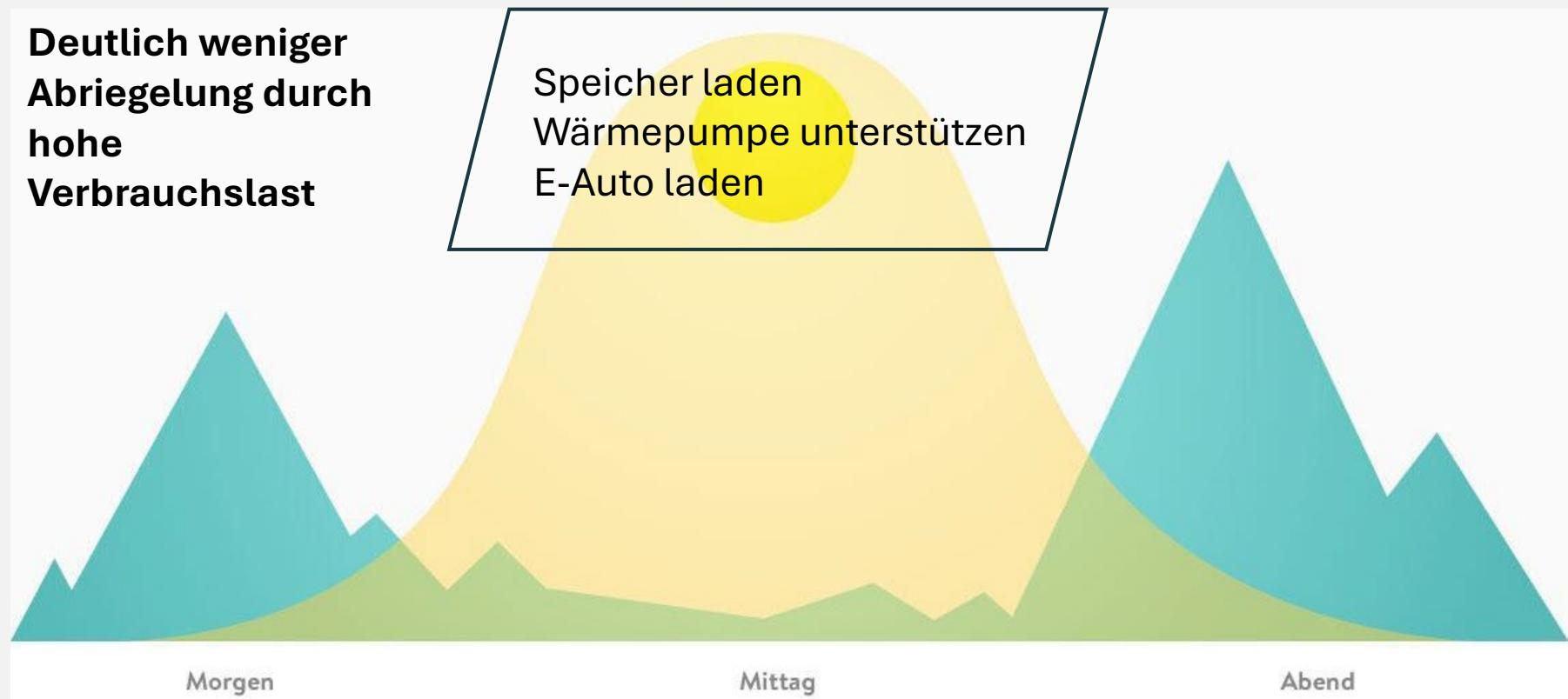
Alle Anlagen ab **7kWp** werden nach und nach durch den Smart Meter-Einbau **regel - und steuerbar** gemacht. Die Regelung der Anlagen übernimmt dann das EVU über das Smart Meter und eine Steuerbox. Je nach Netzgebiet wird dies aber 1-3 Jahre dauern.
